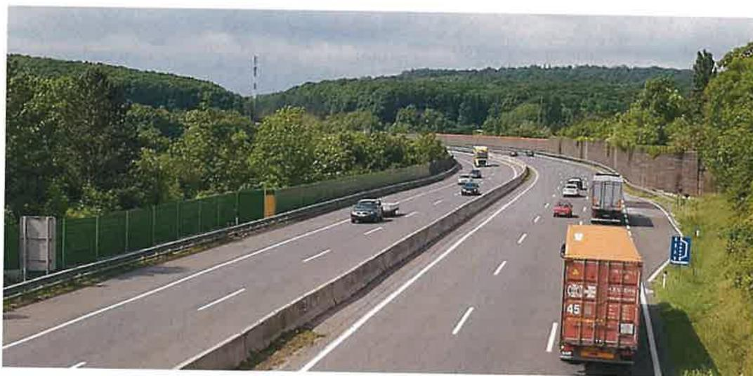
**Lärmschutzwände (LSW) entlang der Autobahn A21 mit Blickrichtung Westen in drei verschiedenen Ausführungsformen; im Abschnitt der Brücke ist der Zustand der LSW gesamthaft besser im Vergleich zu den Elementen im davor liegenden Abschnitt**
